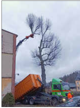
Mithilfe eines Fällkrans wurde die Linde Stück für Stück abgetragen.
