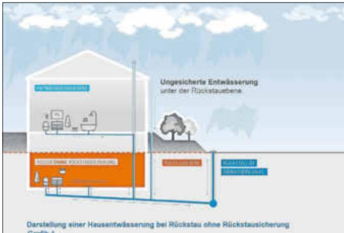
Bei starken Niederschlägen kann es zu Schäden kommen, z. B. überschwemmte Kellerräume, die durch Rückstau von Abwasser aus der öffentlichen Kanalisation entstehen. Nur die rechtzeitige technische Vorsorge durch eine geeignete Installation und Ausrüstung der Grundstücksentwässerungsanlage bietet einen wirksamen Schutz.
